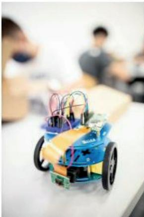
L'ESIEAbot suivra les élèves pendant toute leur scolarité. C'est une plateforme ouverte (Linux), extensible (Raspberry Pi) et programmable (Python, C), qui leur permettra de mettre en pratique les cours sur le numérique : informatique, électronique, robotique, cybersécurité, intelligence artificielle, systèmes embarqués, etc. « Apprendre en faisant » est la devise de l'ESIEA.
